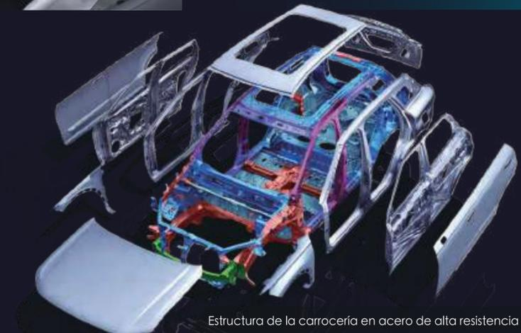
Estructura de la carrocería en acero de alta resistencia
