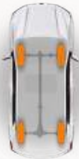
Modo AWD LOCK Utilízalo cuando necesites máxima adherencia al terreno (reparto del par 50/50).
