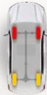
Tracción AWD En caso de necesitar mayor tracción, como en carreteras sin asfaltar o con nieve, el sistema entrega par al eje trasero.
