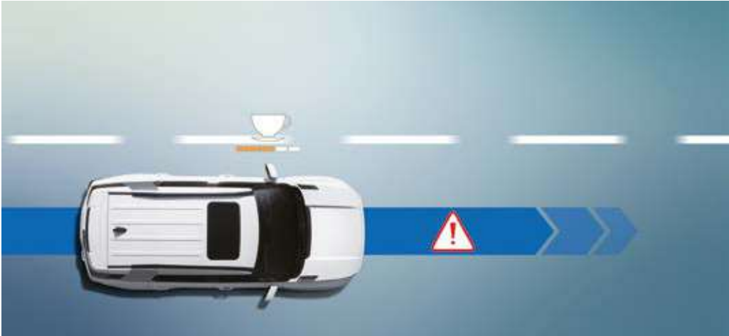
Sistema de advertencia de fatiga (DAA) Cuando el sistema DAA detecta que el nivel de atención del conductor se ha reducido significativamente, emite una advertencia sonora y muestra una imagen en el panel de instrumentos.
