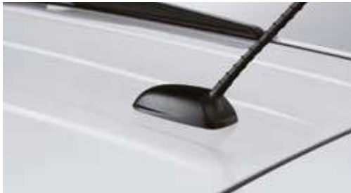
Antena con Glonass, DAB y GSM
