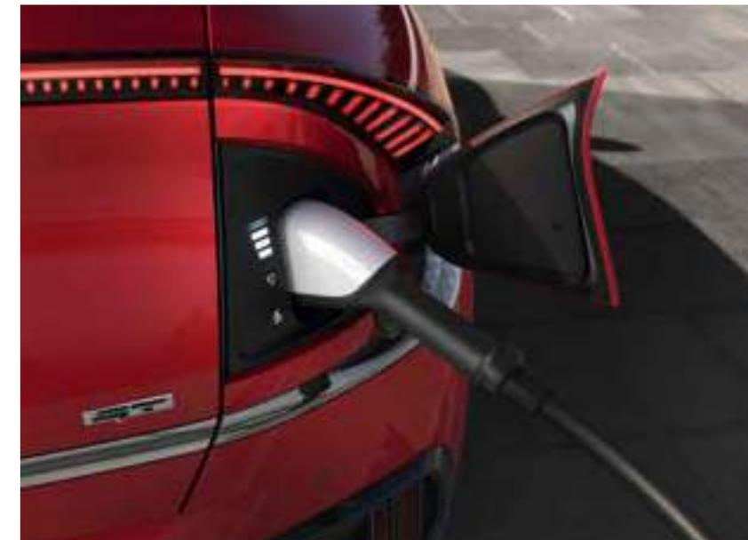
**Puerto de carga inteligente.** La tapa del puerto de carga se abre y cierra electrónicamente. Solo tienes que presionar la propia tapa o el botón a la izquierda del cuadro de mandos en el interior. Bajo la cubierta, un gráfico de barras muestra el nivel de carga.
