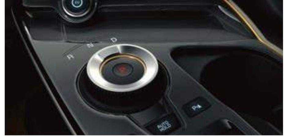
**Consola central - Tecnología de transmisión electrónica shift-by-wire.** La elegante consola central flotante aloja un control giratorio eléctrico para seleccionar con rapidez y precisión entre las distintas posiciones del cambio de marcha. La parte superior de la consola también incluye un puerto de carga inalámbrica integrado y en su interior encontrarás espacio de almacenamiento adicional.
