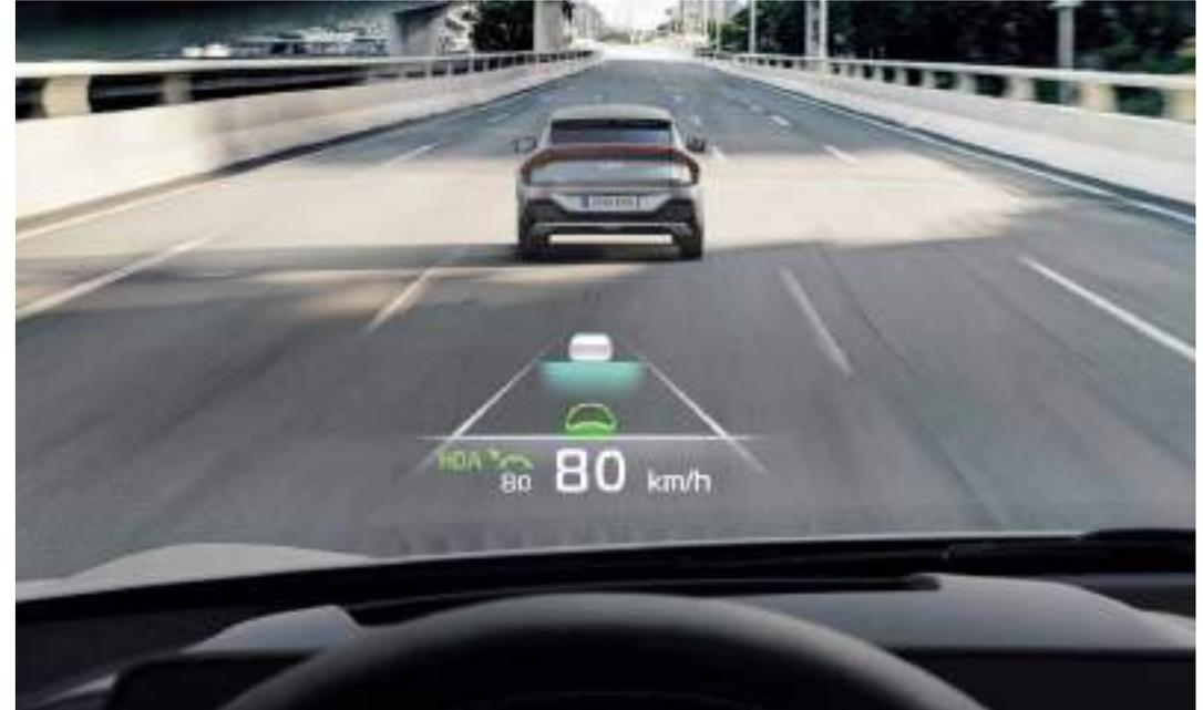
**"Head- up display" con realidad aumentada (AR-HUD).** El nuevo proyector en el parabrisas "head- up display" presenta una pantalla virtual sobre el parabrisas para orientarte hasta tu destino. Muestra las indicaciones de navegación sobre las calles que ves ante ti y te ofrece toda la información necesaria para viajar de forma segura y sin problemas. (Equipamiento según versión).
