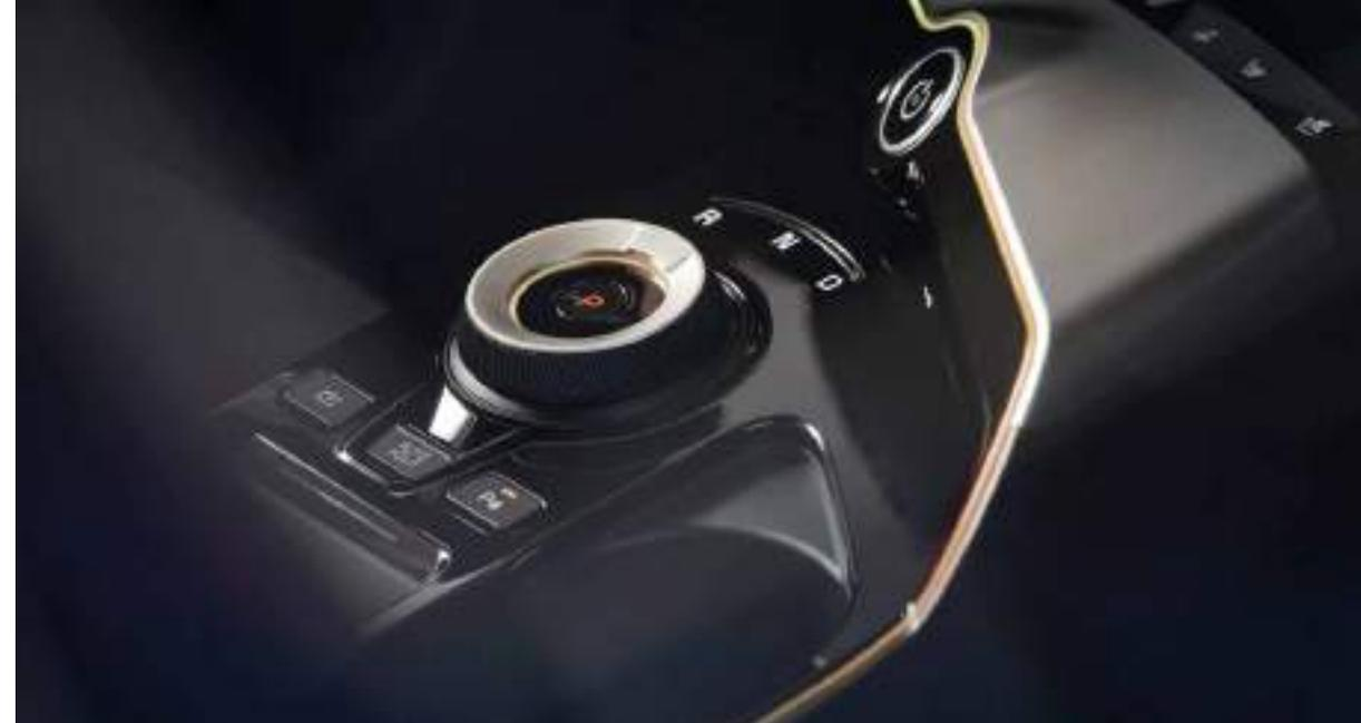
**Selector de cambio Shift-By-Wire (SBW).** Lo único que necesitas para cambiar entre marcha atrás, punto muerto y "Drive" es pisar el freno y girar el selector del sistema de cambio a la derecha o a la izquierda. El botón P coloca el Kia EV6 en el modo Park para aparcamiento.
