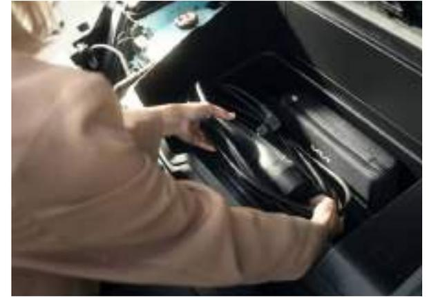
**Compartimento de carga delantero (20 l, 52 l).** El espacio adicional es una ventaja útil de la nueva plataforma del Kia EV6, que incluye un práctico espacio de carga bajo el capó delantero con hasta 20 litros de capacidad en los modelos AWD y hasta 52 litros en los modelos 2WD.
