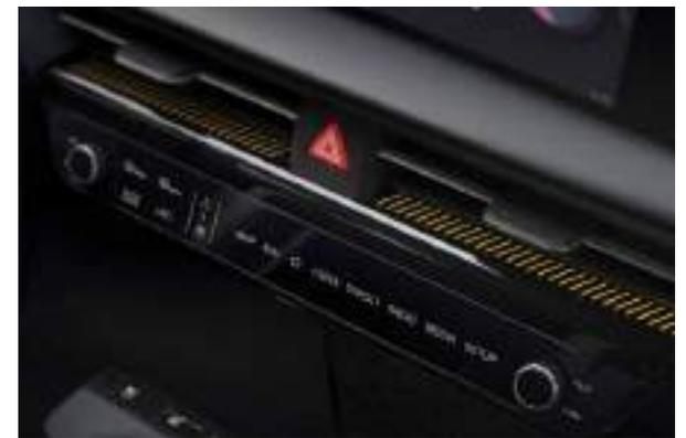
**Controlador seleccionable de infoentretenimiento y climatización.** El controlador seleccionable ofrece una forma intuitiva de interactuar con el vehículo y mantiene toda la información importante al alcance de tu mano. Pulsa con un sólo toque el icono de infoentretenimiento o de climatización y, después, los menús relevantes para realizar cualquier ajuste que desees.
