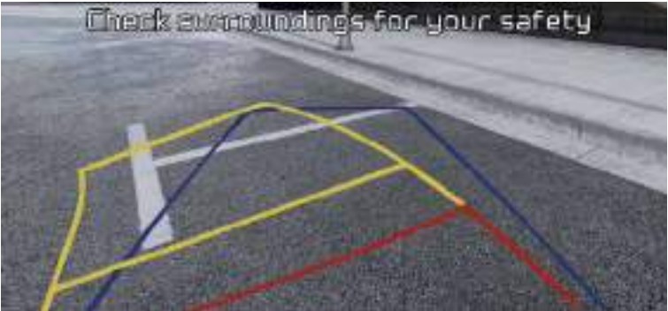
Cámara de asistencia al estacionamiento. Proyecta guías dinámicas y curvadas en la imagen de la pantalla de 20 cm (8") del salpicadero.
