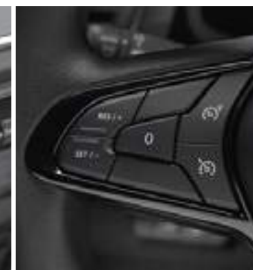
Control de crucero**
