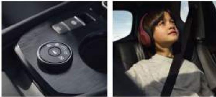
Control de cambio de modo de conducción 4x4\*.
